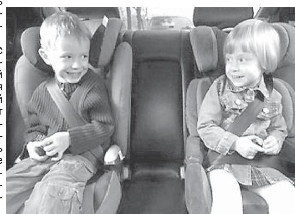
ремнями безопасности с креплениями в трех точках в случае столкновения или резкого торможения транспортного средства уменьшают опасность ранения ребенка, который находится в этом устройстве, путем ограничения подвижности его тела. Не допускается застегивание двух детей или взрослого с ребенком одним ремнем безопасности с удерживающим устройством или без него.
